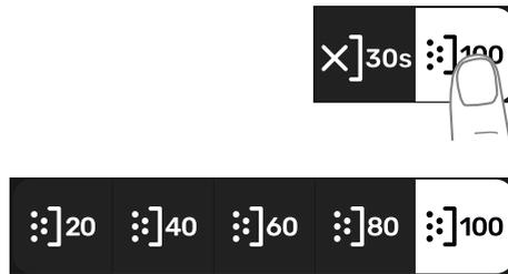
Um Probenmaterial zu sammeln, können Sie die Saugfunktion für kurze Zeit auch ganz ausschalten. Die Dauer, für die die Saugfunktion ausgeschaltet ist, ist auf 30 Sekunden begrenzt. Nach Ablauf der 30 Sekunden schalten sich das Handstück und die Absaugung automatisch ab. Danach schaltet das Gerät wieder auf 100 % Absaugleistung.
